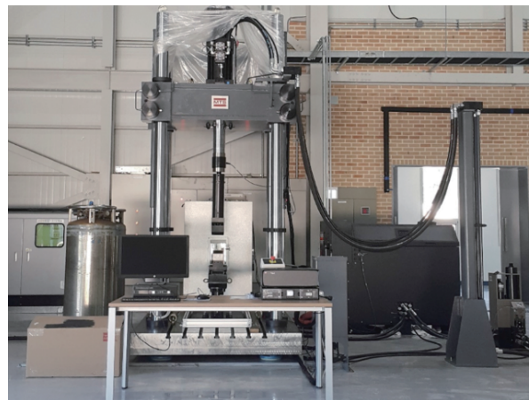
그림 11. 500kN 초저온/고온 동적 피로시험기
